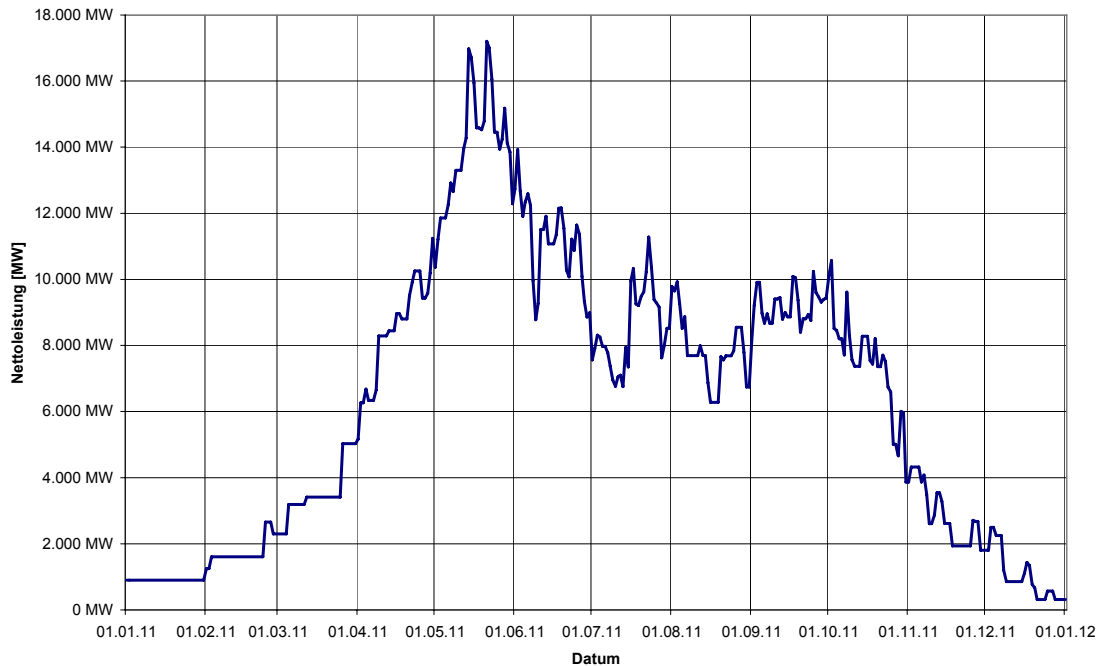
Abbildung 18: Revisionsbedingte planbare nichtverfügbare Nettoerzeugungsleistung unter Berücksichtigung des Moratoriums.
