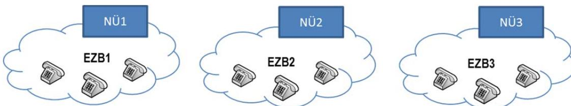
Die Netzübergänge (NÜ) verfügen über einen abgrenzbaren Einzugsbereich (EZB) und bilden damit eigenständige Teile der uNKE.
