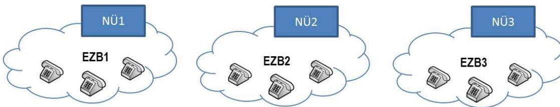
Die Netzübergänge (NÜ) verfügen über einen abgrenzbaren Einzugsbereich (EZB) und bilden damit eigenständige Teile der uNKE.
